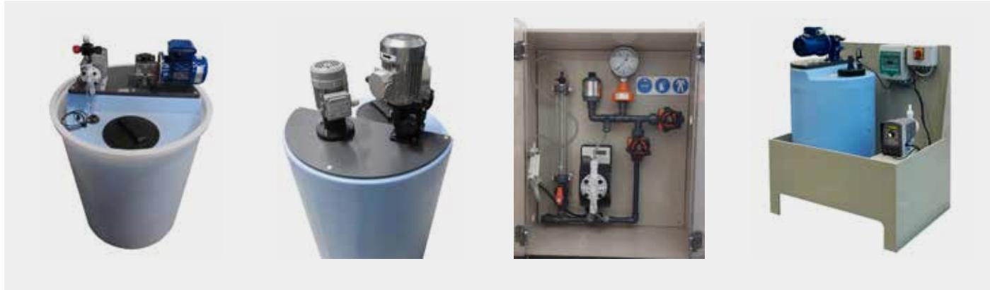
Stazioni di dosaggio con serbatoio da 50 a 1000 litri, che possono includere pompa dosatrice elettromagnetica o a motore, agitatore elettromeccanico di diverse tipologie o manuale, lancia di aspirazione con sensore di livello o tubo di calma, camicia di sicurezza.
