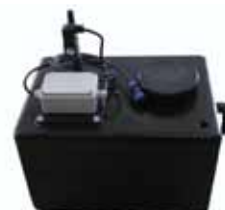
Tanque agua (40 L), completa de válvula solenoide y sensores de nivel
