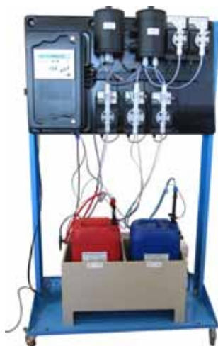
Cuba compacta con compartimiento agua y alojamientos para tanques de reactivos
