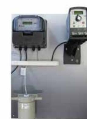
Medición de conductividad y dosificación con bomba PSP161
